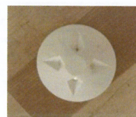
温度分布センシングユニット(Grid-EYE)
