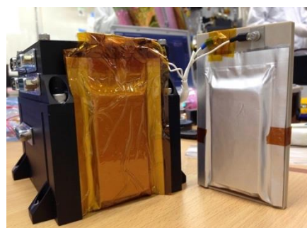
図 人工衛星搭載のラミネート外装イオン液体 Li-ion 電池と制御モジュール(後の黒 block)。
